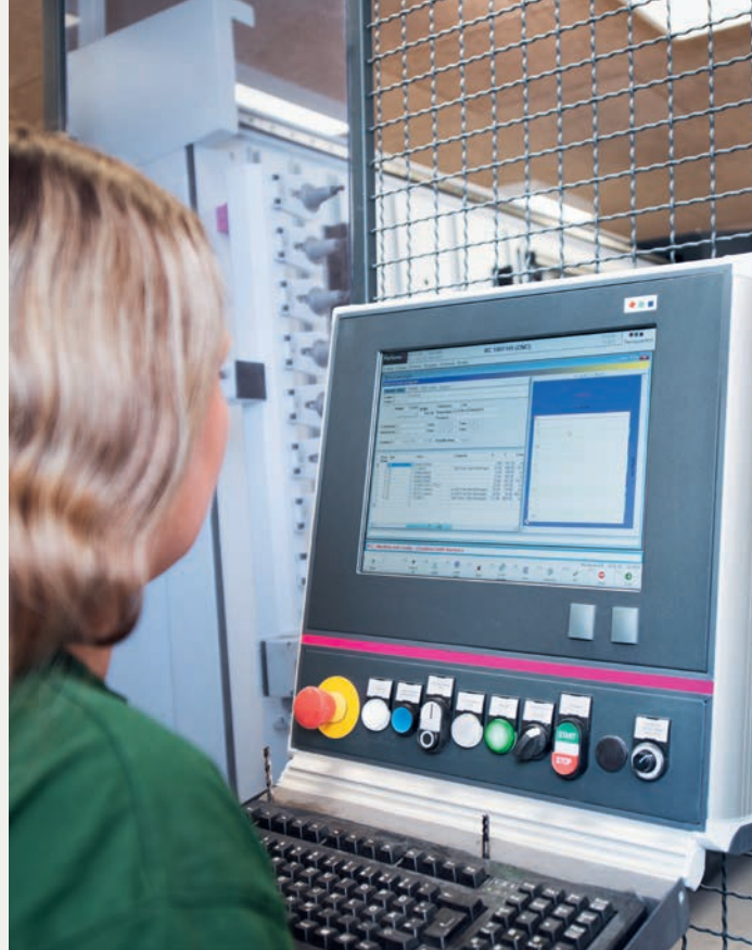
Fra projektafdelingen sendes tavlen data og virtuelle tegning til produktionsanlægget, som fræsede alle huller i stål kabinet i en fuldautomatisk proces.
