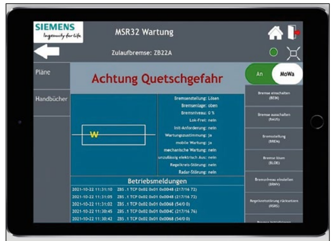
Bild 4: Bedienung einer hydraulischen Bremse per Tablet
