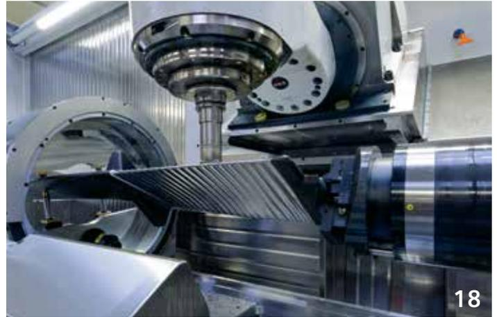
**18:** Die Geometrie von Turbinenschaufeln bestimmt die Effizienz von Flugzeugantrieben, Dampfturbinen oder Turboladern. Die neuen Fräszentren der Firma StarragHeckert sind Profis bei deren Herstellung und kommen dabei ohne nachträgliches Bearbeiten aus.
