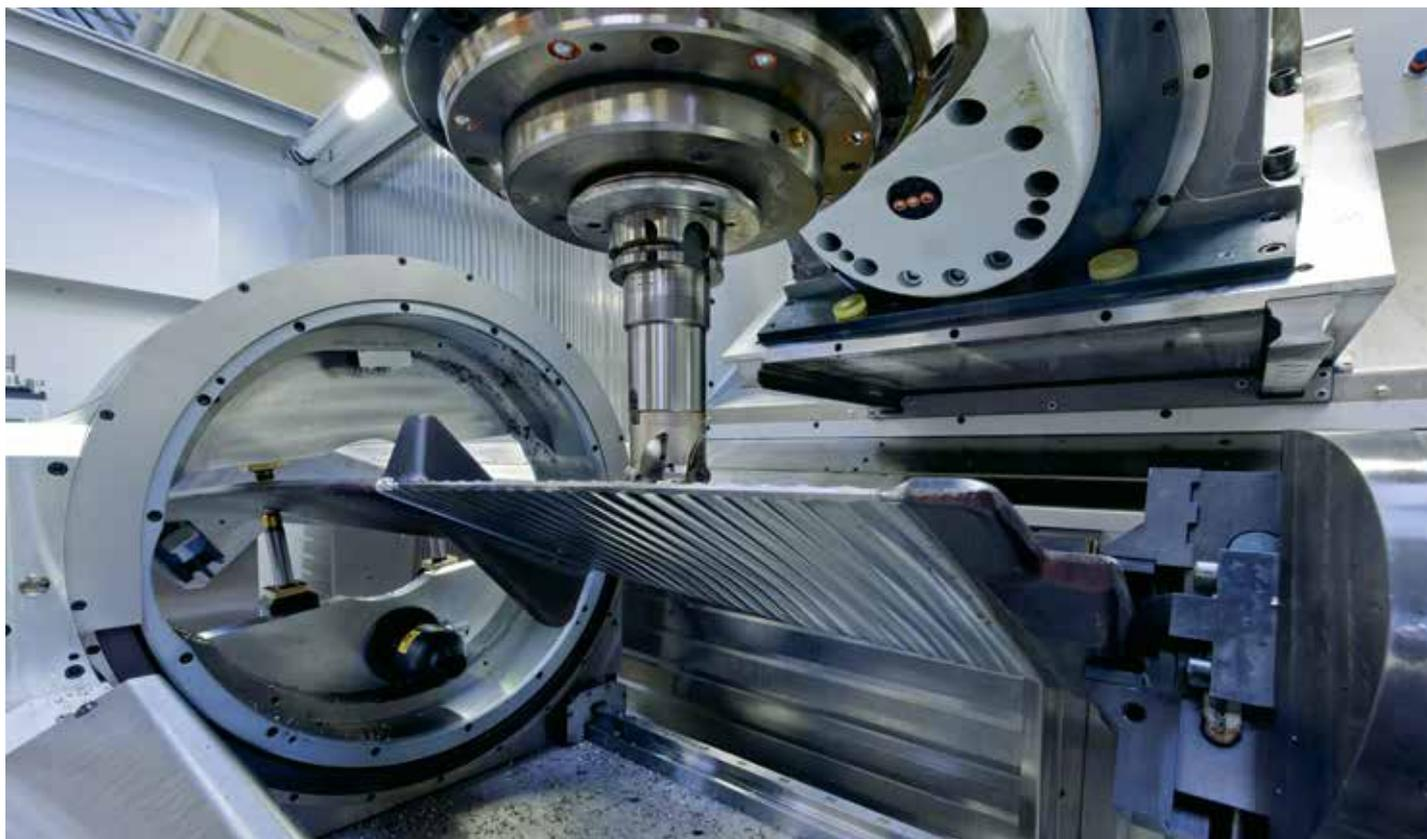
Die bis zu zwei Meter grossen Turbinenschaufeln werden im Hundertstel Millimeter-Bereich genau gefräst.
