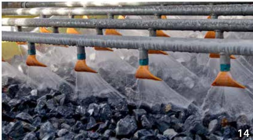
14: Erstmals in der Schweiz kam bei der Steuerung einer Anlage im Kieswerk Untervaz die neue Engineering-Plattform TIA Portal von Siemens zum Einsatz. Die Anlage wäscht Bahnschotter, bevor er verladen wird.
