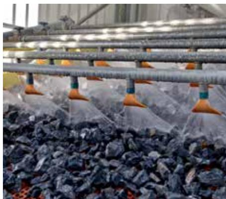
Auf einem Kreisschwingsieb wird der Schotter mit Wasser gewaschen.
