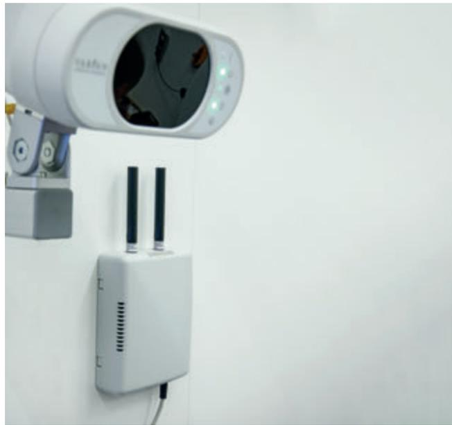
Der Access Point, mit dem extra angefertigten Spritzgussgehäuse, überträgt die Daten zur Atmung des Patienten von der Kamera auf das Visual Coaching Device.
