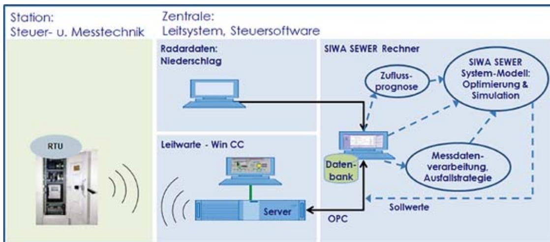
Der Erftverband verknüpft im Bestandsnetz Kenten seit zwei Jahren Radardaten mit Modellen für die Zuflussprognose und die Anlagensteuerung.
