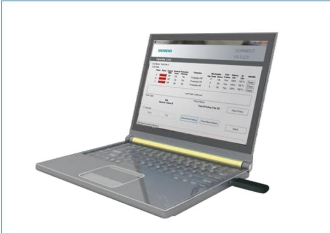
Le module de communication du Fusesaver™ communique avec une antenne USB
