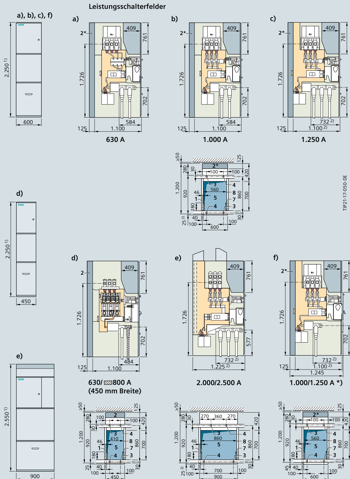
Abb. 3/4: Front- und Seitenansichten sowie Aufstellflächen mit Bodenbefestigungspunkten für Leistungsschalterfelder mit Kabelanschluss unten (Maße in mm; Legende und Fußnoten siehe Abb. 3/3 auf S. 54)
