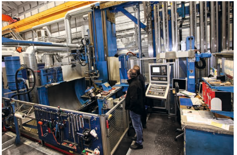
Dragbrottsmaskinen i Ljungströmsverkstaden i Finspångsanläggningen.
