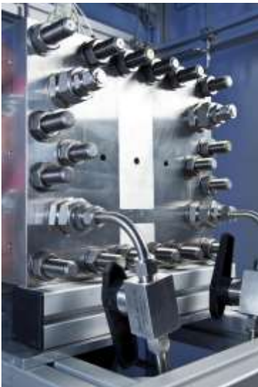
Hydrogen Electrolyzer: Detailaufnahme vom PEM-Stack mit Zellen und Membranen.
