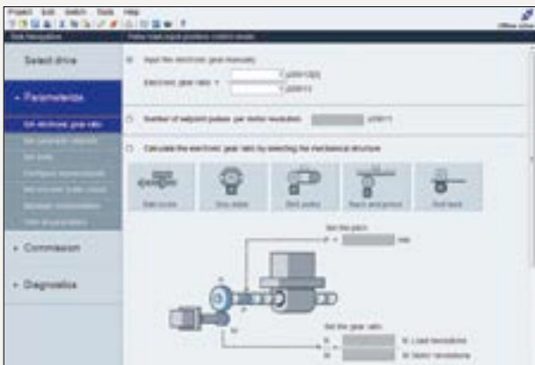
ガイド付きの機械装置の試運転のためのユーザタスク中心の構造
