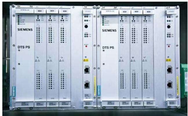
Die Übertragung erfolgt über eine ISDN- oder Ethernet-Verbindung zwischen zwei oder mehr DTS-Geräten. Mit ISDN ist über eine Kupferleitung eine Reichweite bis zu 20 km möglich. Sollte die Leitungsqualität nicht ausreichen, kann ein zusätzliches Wayguard Simis DTS-Gerät in „Repeater-Funktion“ oder ein ISDN-Repeater zur Erhöhung der Reichweite eingesetzt werden. Bei einer Ethernet-Verbindung über ein vorhandenes IT-Netz oder ein LWL-Kabel spielt die Entfernung keine Rolle.
