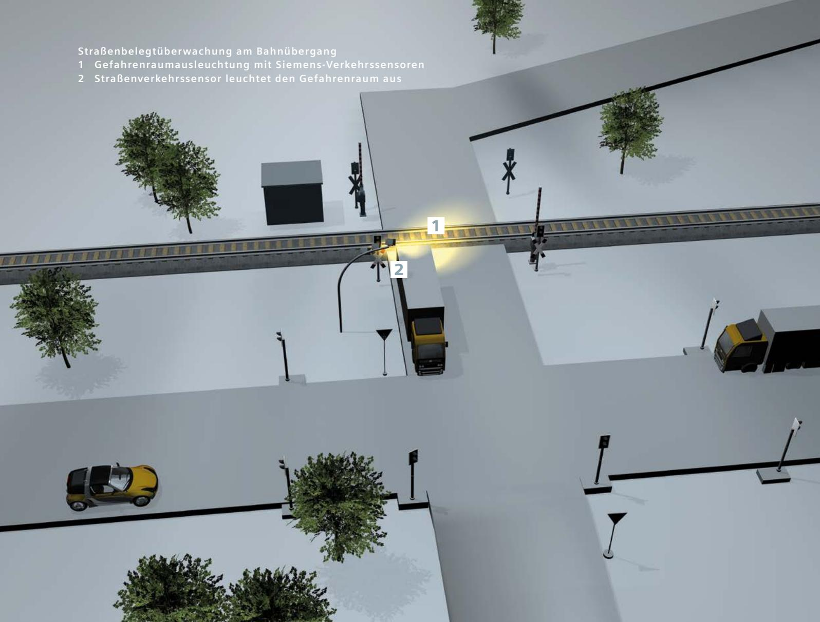
Die installierten Straßenverkehrssensoren haben ein Fahrzeug detektiert und bewirken in der Bahnübergangssicherungsanlage Wayguard Simis LC die Anschaltung der vorgeschalteten Lichtzeichen. Das Räumen des Bahnübergangs kann nun erfolgen.
