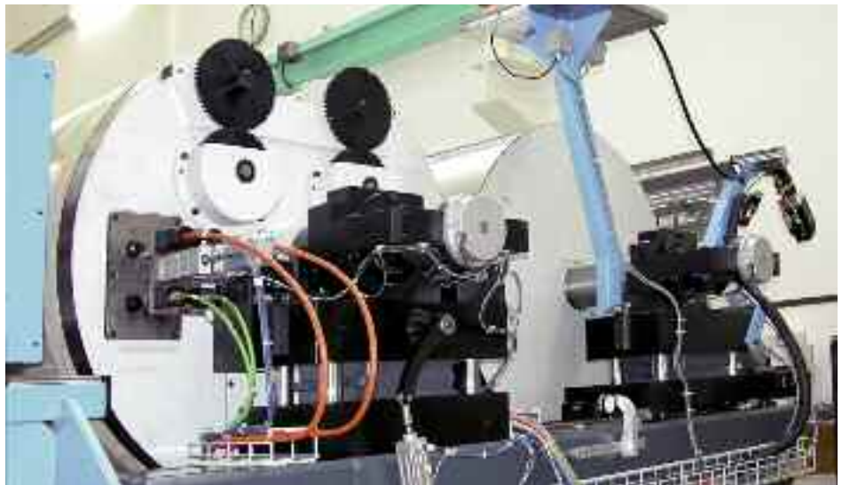
Der hochpräzise Druck auf Glasplatten erfordert extrem genau koordinierte Bewegungsführung, hohe Dynamik sowie absolute Synchronität der Antriebe und schnell reagierende Steuerungen.
