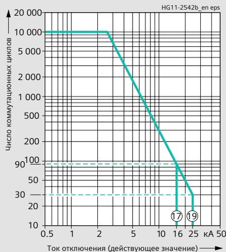
Максимально допустимое количество электрических коммутационных операций показано как функция тока отключения (ср. кв. значение). Все вакуумные силовые выключатели SION удовлетворяют требованиям классов коммутации E2, M2 и C2 согласно МЭК 62271-100
