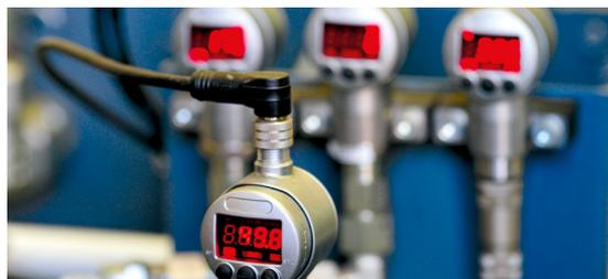
Überwachungsorgane der hydraulischen Steuerung
