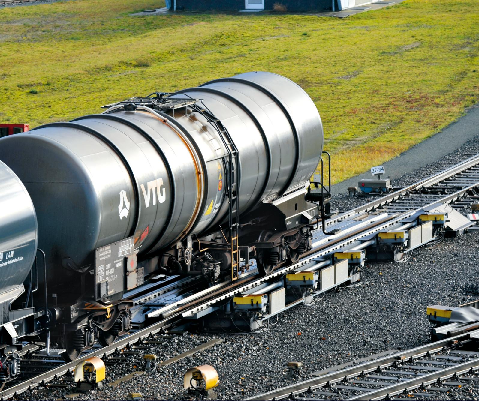
DAS VARIABLE GLEISBREMSSYSTEM ZUR GESCHWINDIGKEITSREGELUNG IN ZUGBILDUNGSANLAGEN
