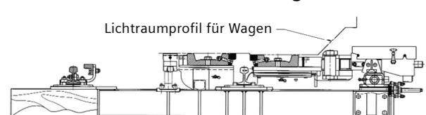
Betriebsstellungen einer einschiennigen Balkengleisbremse, Bauart TW-E
