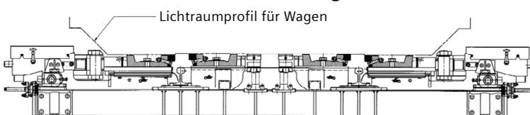
Betriebsstellungen einer zweischiennigen Balkengleisbremse, Bauart TW-F
