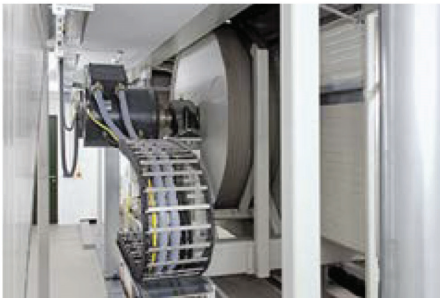
EL DINAMÓMETRO DE RODILLOS COMPACTO VISTO DESDE ABAJO, EQUIPADO CON MOTORES DE PAR SIMOTICS T-1FW3 DE SIEMENS
