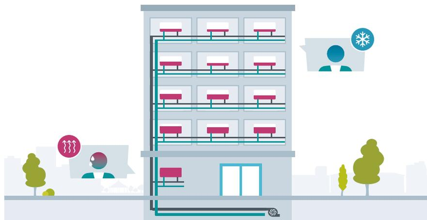
Équilibrage hydraulique statique : répartition inégale de l'énergie dans des conditions de charge partielle.
