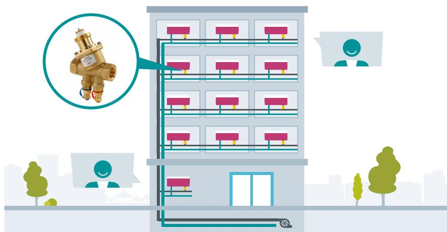
Équilibrage hydraulique dynamique : le système hydraulique est toujours équilibré, indépendamment des conditions de charge et des fluctuations de pression.
