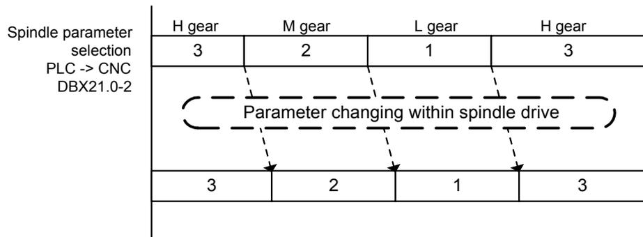
Fig. 14.10 Spindle parameter selection time chart
