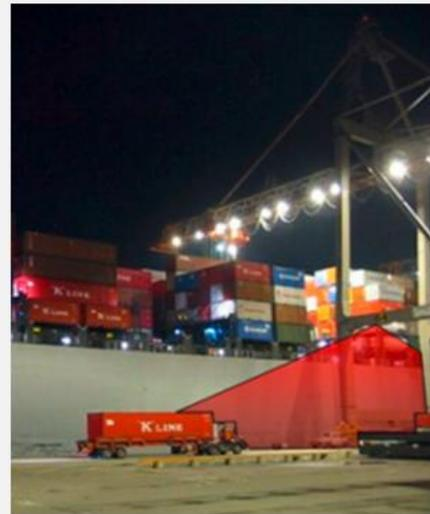
本项目是我们第一个完成的半自动化项目，系统中使用了多个西门子或第三方的自动化子模块。在没有经验可以参考的情况下，在消化各种的手册资料后，采购清单中没有错误。在安装和调试，遇到不少麻烦，肖自立和李亮日夜加班，经过不断尝试和完善，最终难题都解决。这也给后续的项目提供了经验。项目中使用了西门子卡车定位系统，引导卡车司机停车，精确度达到 6cm 以上，卡车定位系统能减轻卡车司机的工作量；提高卡车和起重机的配合，能提高起重机的工作效率。西门子防摇系统，能减轻钢丝绳下负载的摆动；在半自动模式时，把船型扫描系统扫描出的轮廓值给防摇后，防摇系统能计算出最优路径，并且绕开障碍物，半自动模式时能提高安全和可靠性，也能提高起重机的效率。
