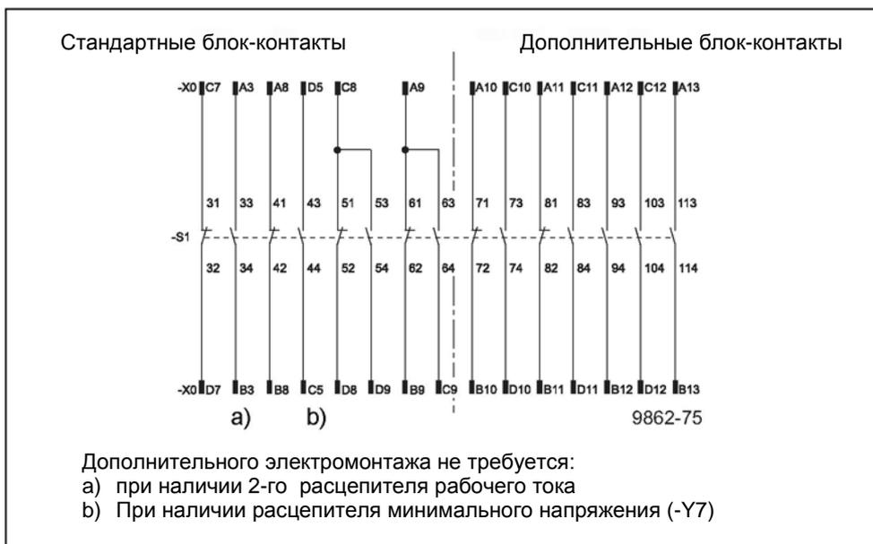
Рис. 33 Пример - выводы блок-контактов
