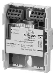
Изолятор линии FDCL181 используется для выявления и отключения короткозамкнутых участков в шине FD18-BUS. Он также подключается для предотвращения одновременного сбоя разных ветвей системы вследствие короткого замыкания.
