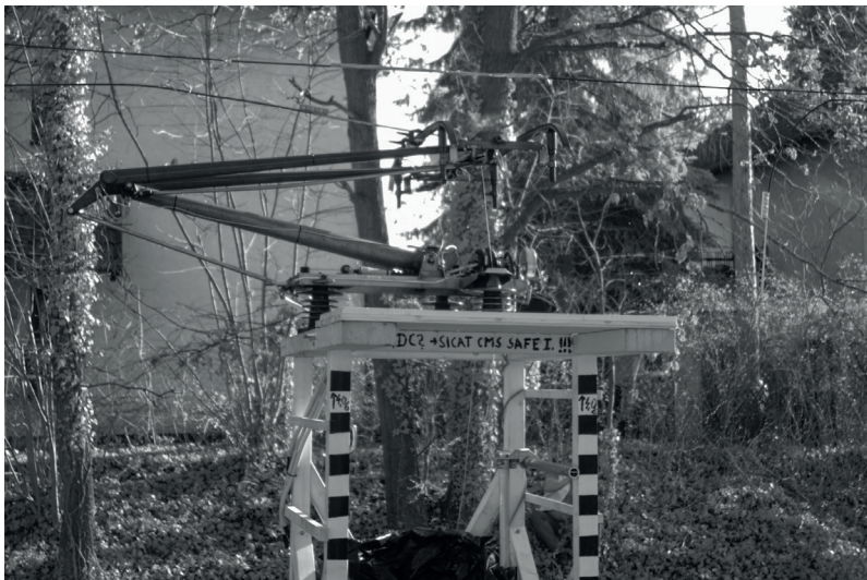
Bild 19: Verhalten des durch Abschmelzen per Stromabnehmer gerissenen Fahrdrabtes rund 1 s nach Fehlereintritt und auf 3 m verkürztem Hängerabstand bei Fehlereinwirkung etwa 55 m vor dem Festpunkt.
