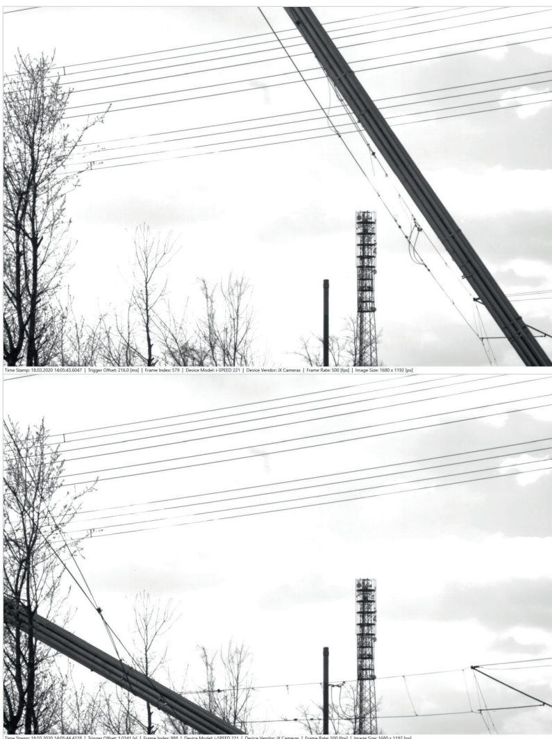
Bild 20: Einschlagversuch mit 600 kg schwerem Rohrbündel kurz vor ( oben ) und nach ( unten ) dem erstmaligen Berühren der Oberleitung.
