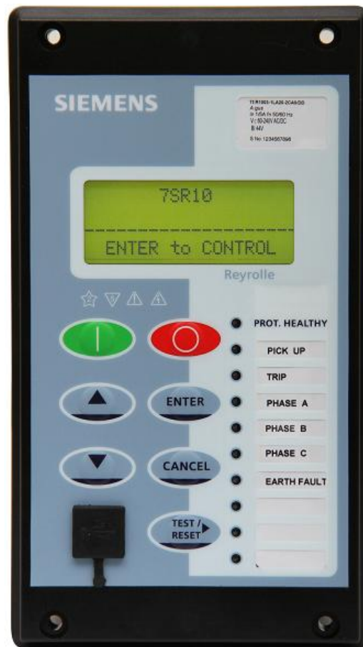
Figura 1.1-3 Pannello di un relè 7SR10 (involucro dimensione E4)
