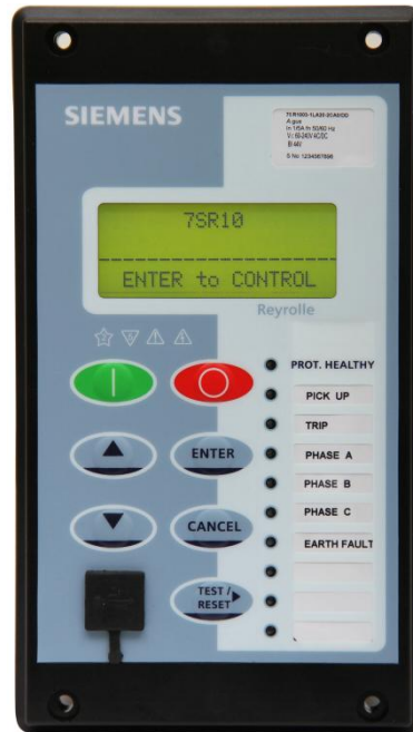
Figura 2-1 Relè di protezione di massima corrente e guasto a terra 7SR10 con pulsanti di controllo
