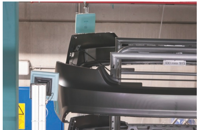
Anhand der RFID-Labels prüft das System auch die Zuordnung der Stoßfänger auf den Lackierskids, was dabei hilft, Schäden an Lackierrobotern und Teilen zu vermeiden.
