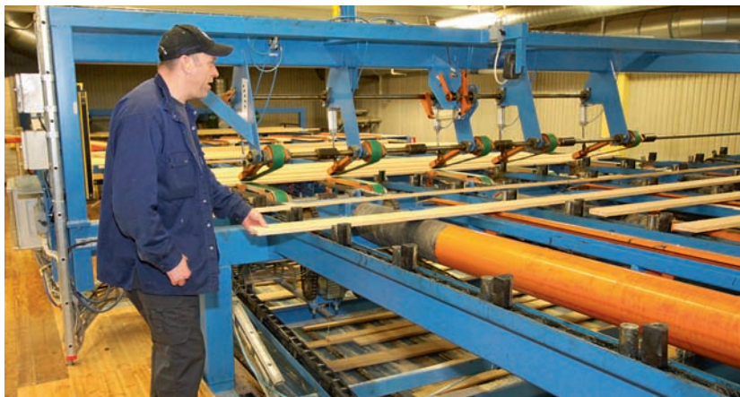
Rune Lundgren, skiftesledare på Malå sågverk, går in i maskinen och rättar till ett fel. Ljusbarriärer och felsäkra styrsystem ser till att det är säkert stopp.
