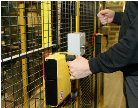
Farliga maskiner omgärdas av gallergrindar från Axelent med grindskyddsbrytare från Siemens.
