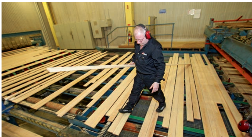
Här gick man förut utan skydd när man skulle rätta till ett fel. Nu måste man passera ett skydd som ger ett säkert stopp.
