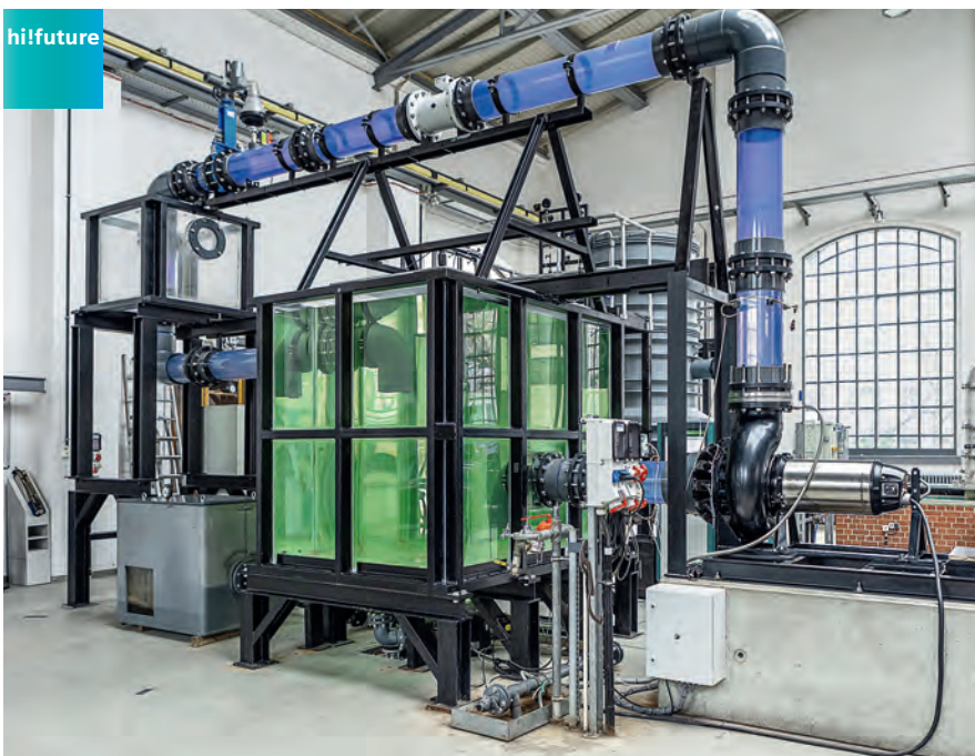
Testna naprava črpalne postaje, ki postopoma dobiva digitalnega dvojčka.
