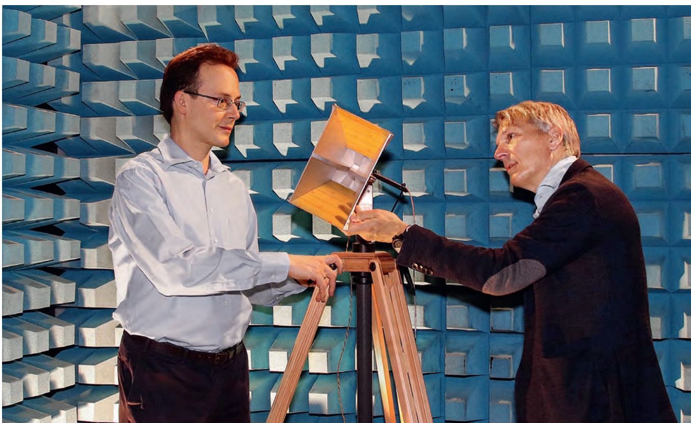
Pogled v laboratorij za visoko frekvenco raziskovalne skupine za radijsko tehnologijo Siemens Avstrija – vodja projekta Georg Kail in vodja raziskovalne skupine Martin Schiefer v prostoru za merjenje absorpcije visokih frekvenc
