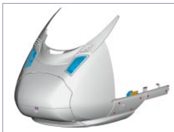
Bild 6: Neu gestaltete Bugnase mit Bugklappen und Scheinwerfern
