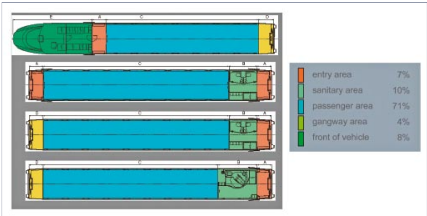
Bild 16: Prinzip „leere Röhre“ für größtmögliche Nutzfläche
