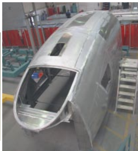
Bild 4: Überarbeitete Konstruktion des Kopfbereiches und erstes Exemplar in der Fertigung
