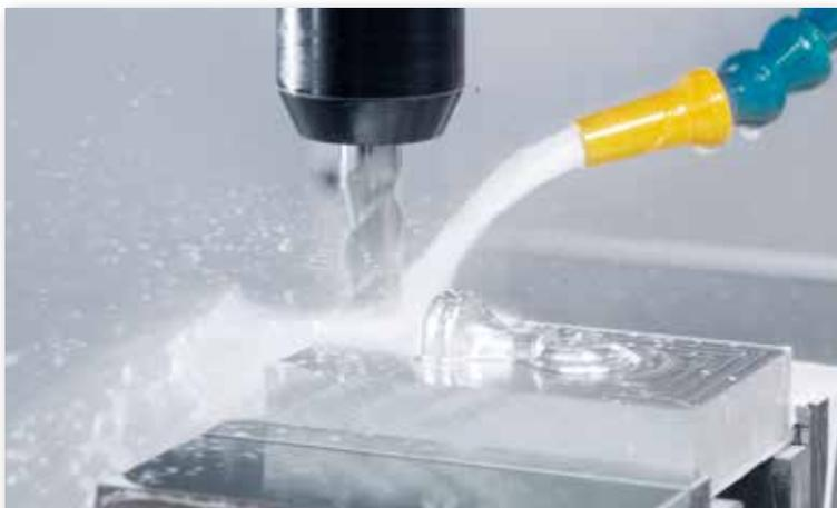
Fraisage de forme en 3 axes, avec SINUMERIK 808D ADVANCED.
