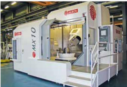
Équipée d'une table de diamètre 1 000 mm pour des courses X de 1 200 mm et Y de 1 200 mm, la MX10 MT embarque des moteurs couples pour la table et la tête. Son changeur d'outils dispose de 48 ou 96 emplacements, voir plus... Cette machine polyvalente s'adresse notamment aux industries du moule, de l'énergie, de l'aéronautique...
