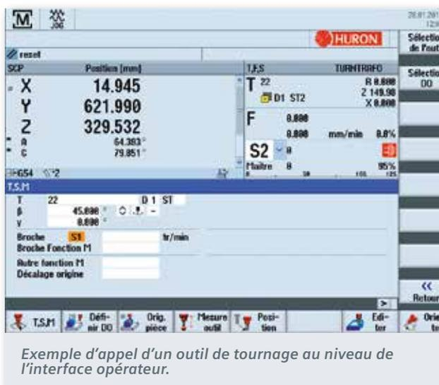
Exemple d'appel d'un outil de tournage au niveau de l'interface opérateur.
