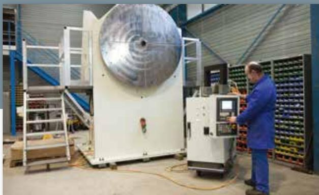
Ce banc mobile permet de tester et de régler en atelier les asservissements de sous-ensembles mécaniques isolés, avant leur montage sur le site du client. Ici avec un positionneur qui complètera une machine de Coriolis Composites.
