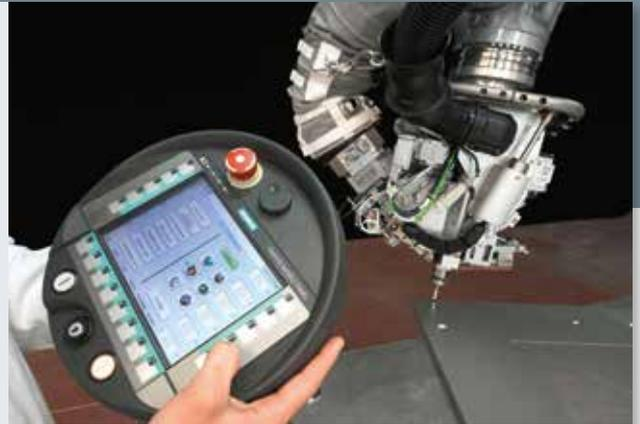
Sur chaque machine, Coriolis Composites intègre une console SIMATIC Mobil Panel (liaison Wifi) pour piloter le robot en mode manuel ou effectuer des opérations de maintenance. Sur la photo : prise d'origine machine.
