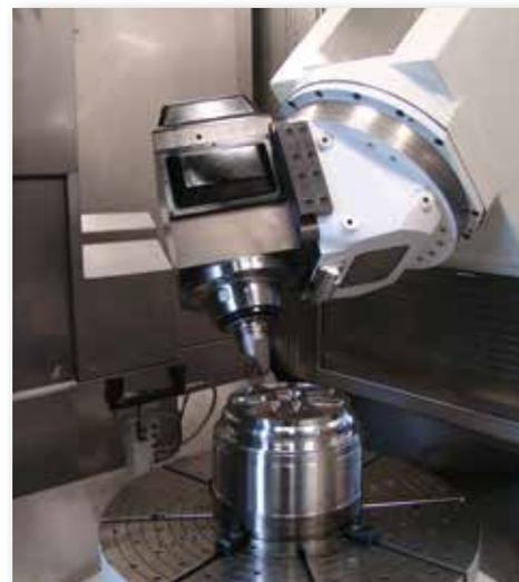
Au-delà du fraisage 5 axes, le MillTurn permet désormais à la 840D sl de réaliser des opérations de tournage avec une fraiseuse 5 axes adaptée.
