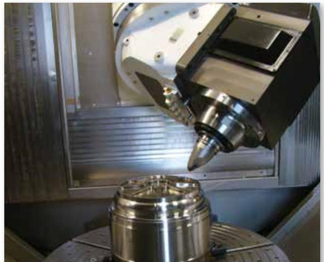
La tête en nutation comporte un système de blocage d'axe pour effectuer des opérations de tournage, grâce au plateau rotatif dont la vitesse a été portée à 500 tr/min.
