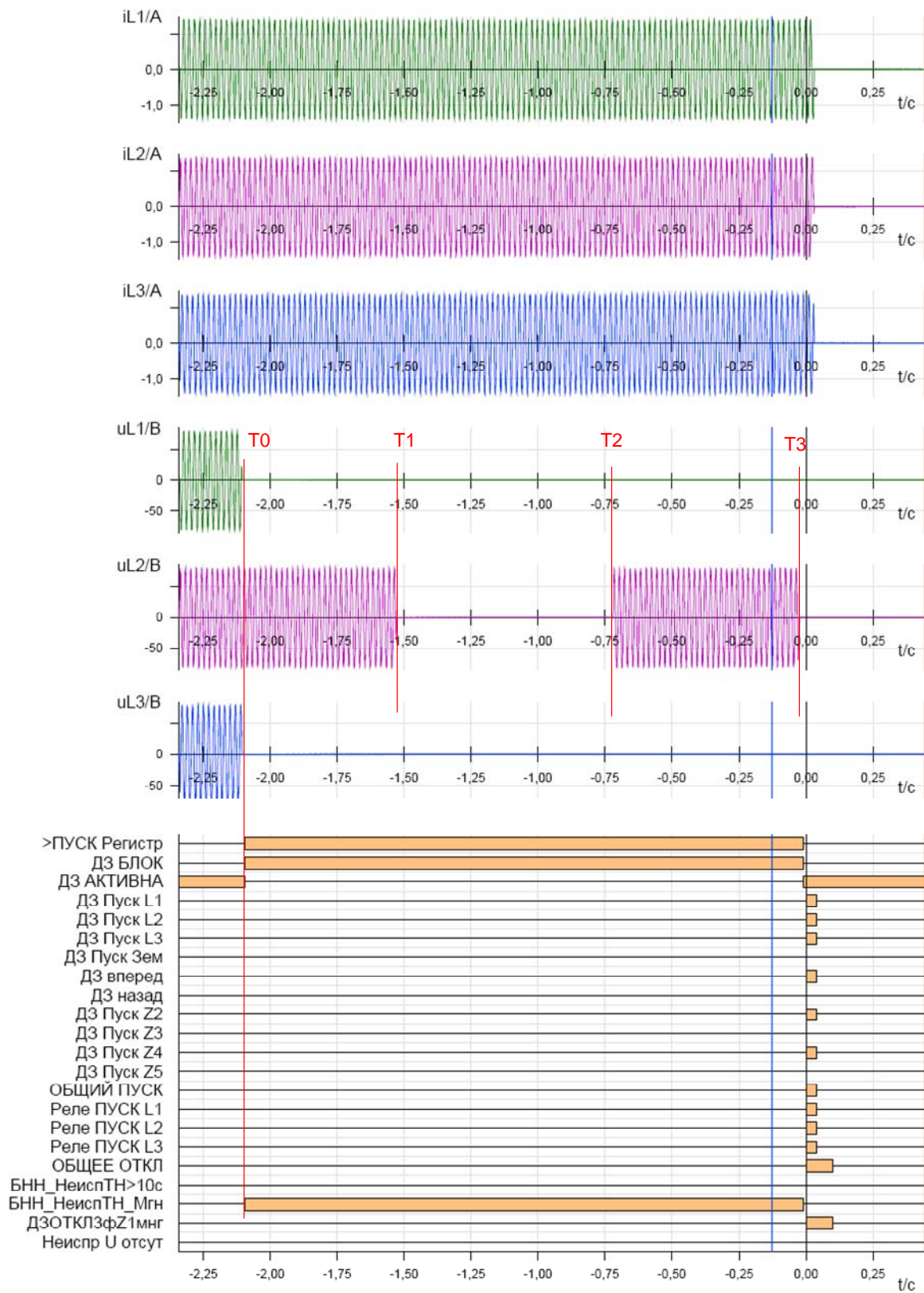
Рис.4 Ложное отключение от ДЗ при действиях дежурного при КЗ в цепях ТН с последующим «отгоранием одной (нескольких) фаз напряжения.
