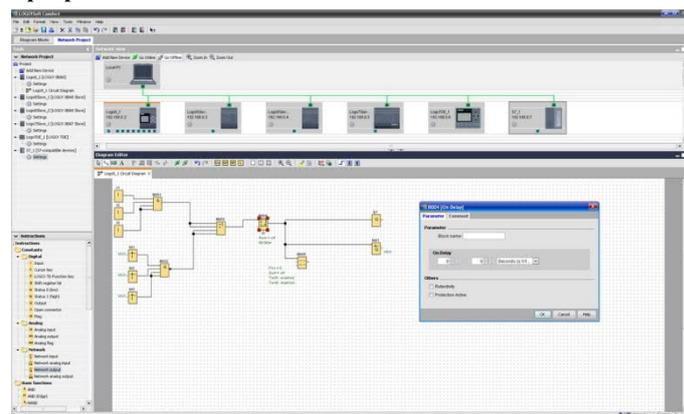
Программное обеспечение LOGO! Soft Comfort V8.2 (LSC) предоставляет наиболее гибкие и широкие возможности по разработке, отладке, документированию и архивированию программ логических модулей LOGO! всех поколений. Дополнительно этот пакет позволяет конфигурировать сетевые соединения логических модулей последних поколений.
