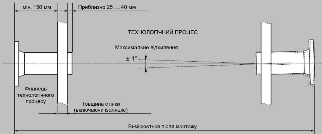
Вимоги до встановлення/вирівнювання пари датчиків
