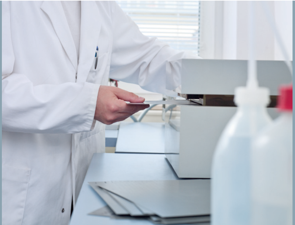
Ummagnetisierungsverlustmessung mittels Single-Sheet-Tester
