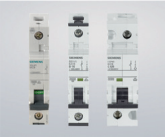
Foto 12.3 Ancho de 18mm por polo hasta los 63A (5SL y 5SY) y de 27mm en 80, 100 y 125A (5SP).
