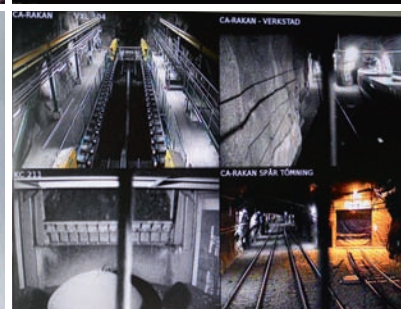
OPERATÖRSSTATION: Härifrån styr operatören tappgrupperna och de lokala skärmarna visar processbilder samt tågens position via kameror längs spåret.
