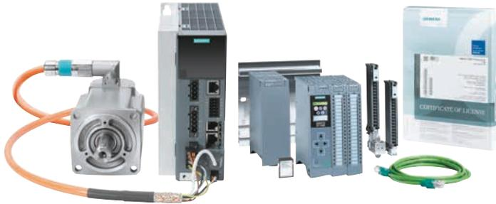
El nuevo servo accionamiento se compone del convertidor SINAMICS S210, un servomotor SIMOTICS S-1FK2 y el cable de conexión OCC ( One Cable Connector ) que incluye potencia, control y freno en un solo cable. El SINAMICS S210 en un drive monoaje AC/AC con un gran rendimiento y respuesta dinámica que permite abarcar un gran número de aplicaciones de Motion Control.
