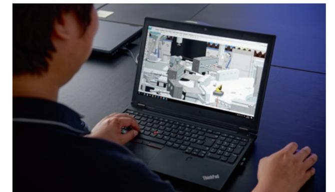
Mit dem digitalen Zwilling konnten sowohl die Mechanik der Anlage als auch die Steuerungen zeitsparend entwickelt und umfassend getestet werden, bevor die reale Maschine in Betrieb genommen wurde.
