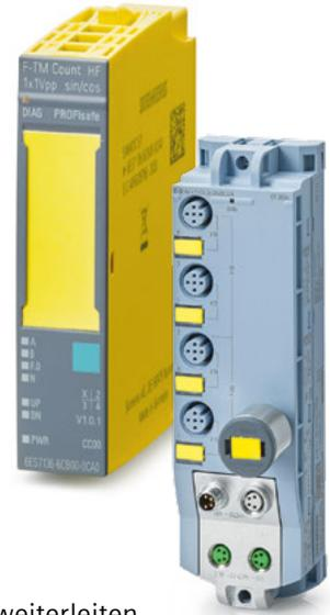
Das F-DI 4/F-DQ 2-Modul erweitert das Produktspektrum der dezentralen Peripherie Simatic ET 200AL in Schutzart IP65/67. Sichere Sensoren und Aktoren lassen sich damit direkt vor Ort an die Maschine anbinden. Über den M12-Anschluss können eingangsseitig entweder zwei einzelne Sensoren oder ein zweikanaliger Sensor angeschlossen werden, beispielsweise ein Positionsschalter oder ein Lichtvorhang.
