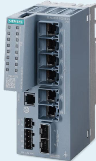
Die Industrie nutzt die aus Büro und Heim bekannte Power-over-Ethernet- (PoE-)Technologie und erweitert mit den Industrial Ethernet Switches Scalance XC-200PoE, XR-100PoE WG und XR-300PoE WG das Produktportfolio der Scalance X-Familie. Für das gesamte industrielle Netzwerk stehen nun passende PoE-Switches für die Versorgung von Überwachungskameras, WLAN Access Points Scalance W, Simatic RTLS Gateways und optische Identifikationssysteme Simatic MV500 zur Verfügung.
