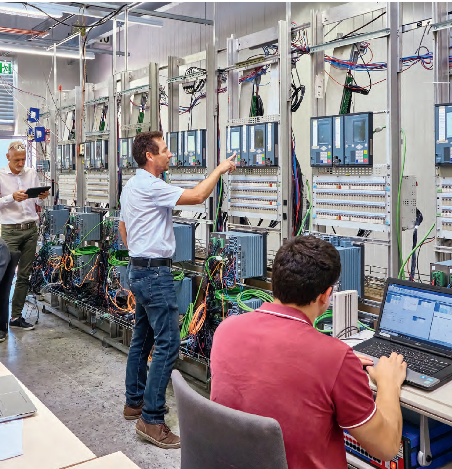
Така изглежда част от конструкцията за виртуално изпитване на управлението и наблюдението на изводите на КРУ за ВН
