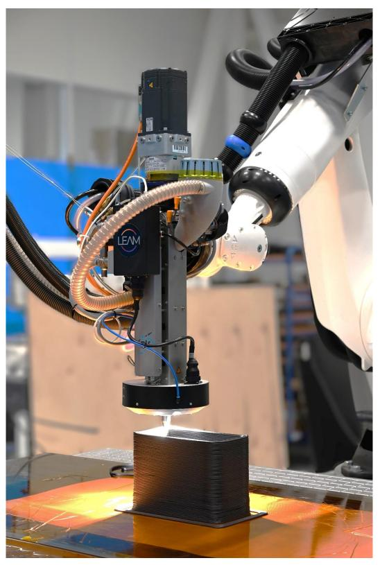
LEAM Technologies revolutioniert die großformatige additive Fertigung (LFAM) mit lichtbasierter Schweißtechnologie.
