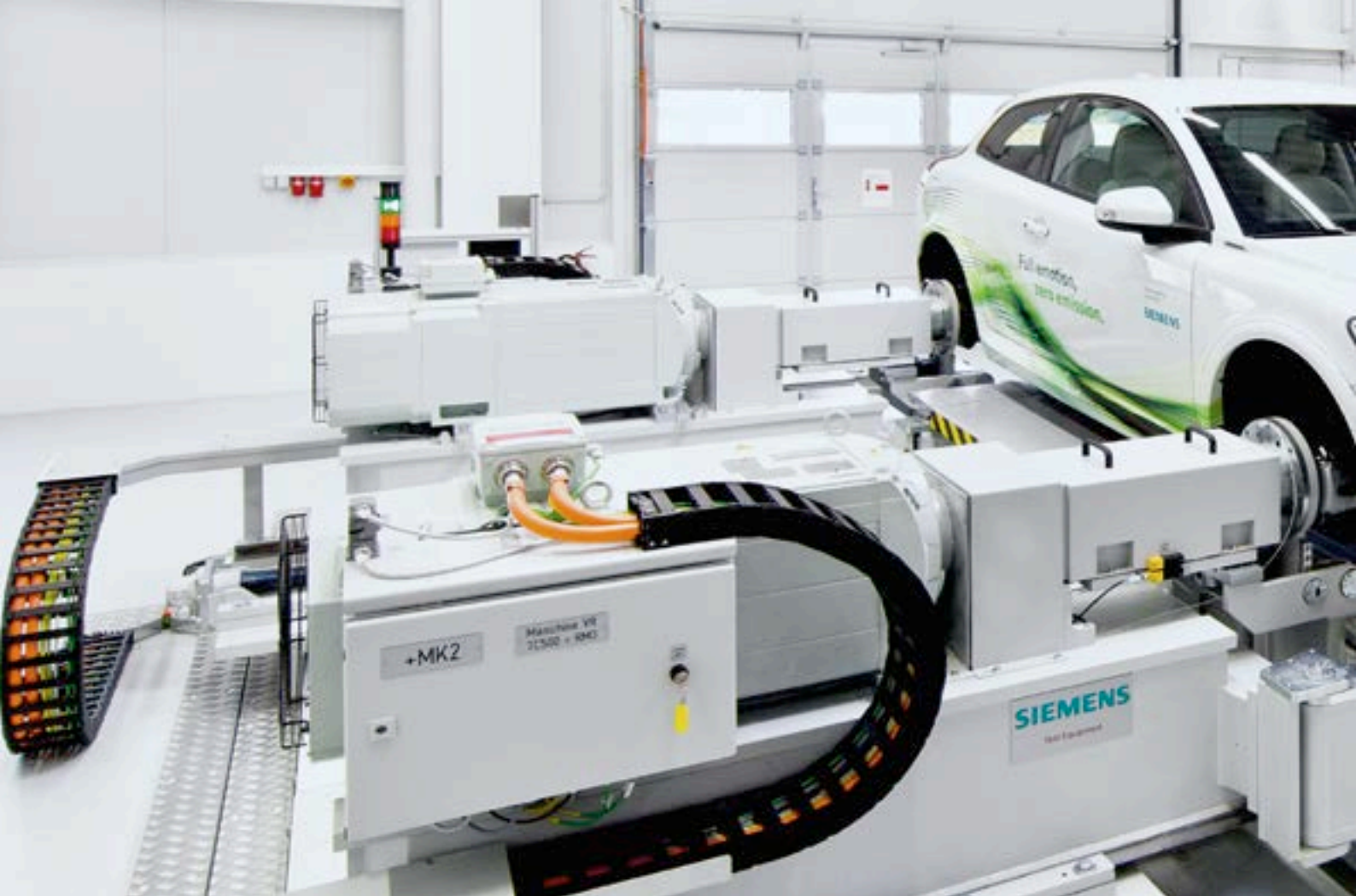
Anwendungsbeispiel für automatisierten Fahrzeugprüfstand mit CATS flexible
