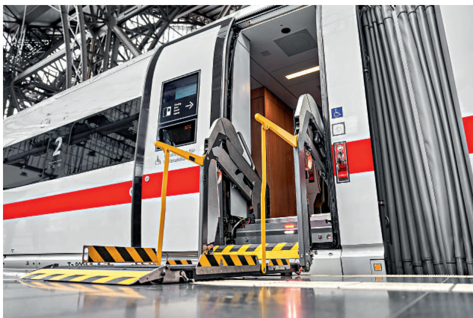
Der neu entwickelte Hublift bei dem für Rollstuhlfahrer reservierten Einstieg (Foto: Siemens).
