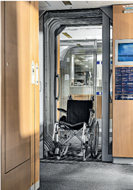
Rollstühle ohne (wie abgebildet) und mit Antrieb passen durch den Wagenübergang (Foto: Siemens).
