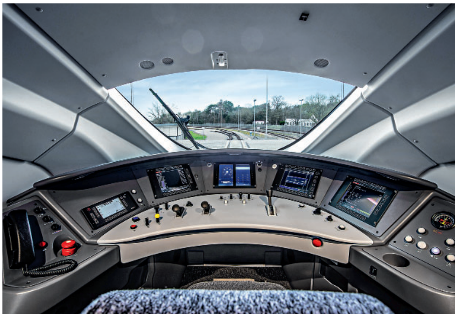
Blick auf das Führerpult mit Driver Machine Interface (DMI) der Zugsicherung in der Mitte (Foto: Siemens).
