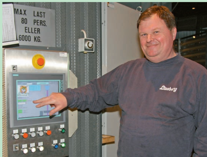
Tre multipaneller Simatic MP 377 med pekskärm presenterar information lättöverskådligt för personalen. Var man än kopplar upp sig kommer man åt alla noder i systemet.
