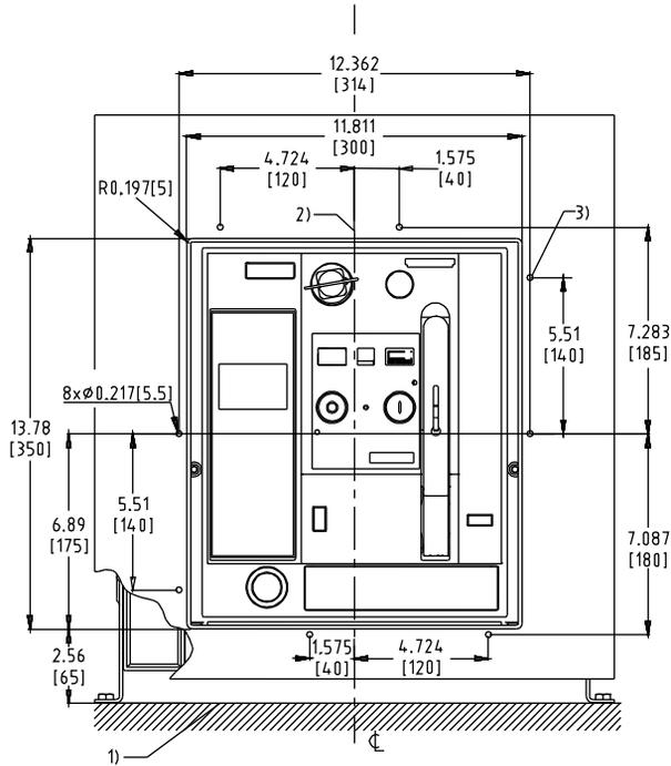
Découpe de porte et trous de montage pour cadre d'étanchéité de porte
