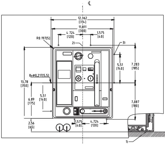
Découpe de porte et trous de montage pour cadre d'étanchéité de porte
