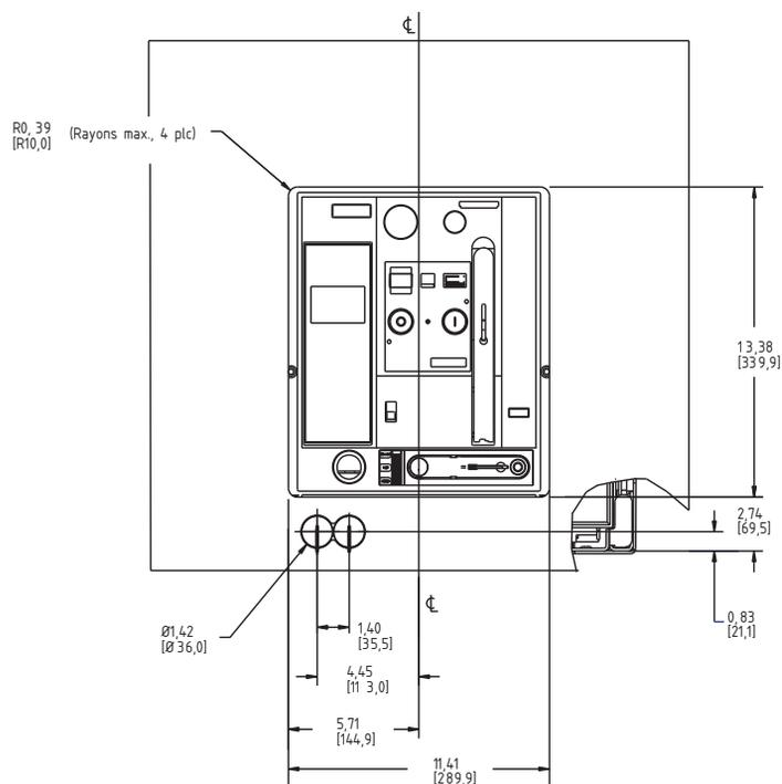
Découpe de porte et trous de montage pour cadre d'étanchéité de porte
