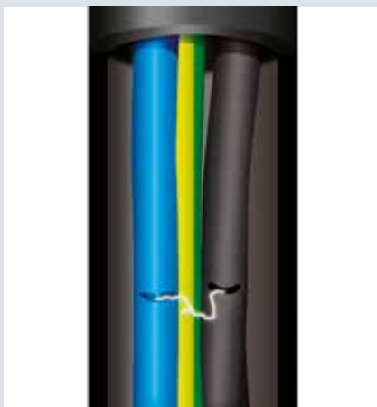
Kontakt zwischen Phase und Neutralleiter
