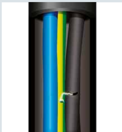
Kontakt zwischen Phase und Schutzleiter
