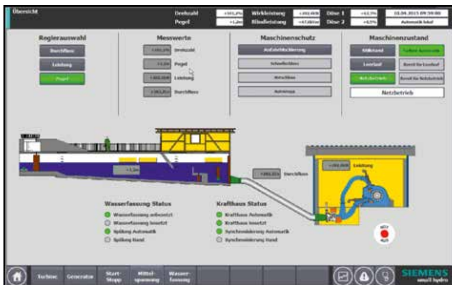
Anleggs oversikt over et lite vannkraftverk med en enkel enhet (skjerm bilde). De relevante målte dataene vises for anleggsdriften. Driftsmodusene, valg av aktiv kontroller og enhetens beskyttelsestilstand er oversiktlig organisert og presentert.
